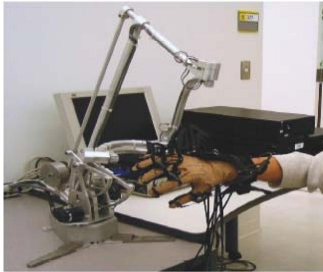
Beispiel eines haptischen Gerätes zur Unterstützung der medizinischen Rehabilitation bei Nervenschäden, Muskelschwäche oder Querschnittslähmung.
