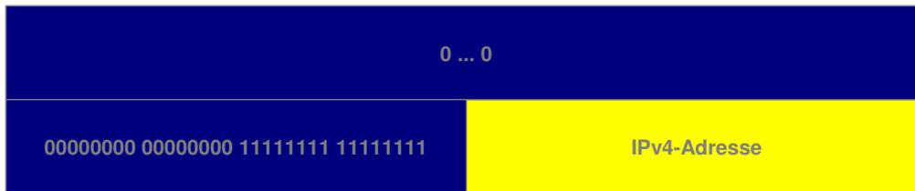
Kommunikation von IPv6-Systemen mit IPv4-Systemen
