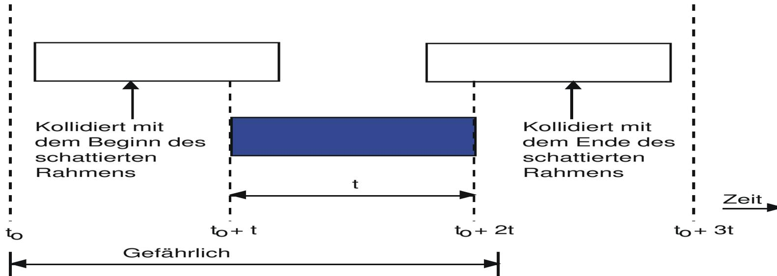
Gefährliche Zeitspanne für den mittlerem Rahmen: Falls auch nur das erste Bit eines neuen Rahmens das letzte Bit eines fast beendeten Rahmens überschneidet, werden beide Rahmen total zerstört, beide müssen später nochmals übermittelt werden. Eine Prüfsumme kann nicht (und sollte auch nicht) zwischen einem totalen und einem knappen Verlust unterscheiden. Knapp daneben ist auch vorbei!
