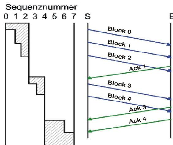
Dieselben Sequenznummern werden in den meisten Protokollen **sowohl** zur Fehlerkontrolle **als auch** zur Flusssteuerung verwendet!
