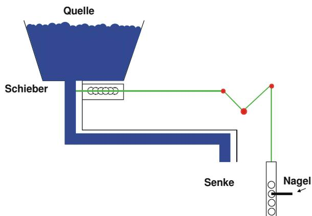
Stellt eine Rückkopplung zur Verfügung, um zu verhindern, dass der Sender den Empfänger überschwemmt.
