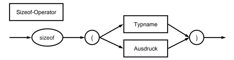
C verwendet den unären Operator sizeof, um die Anzahl von Bytes zu bestimmen, die zur Speicherung eines Objektes benötigt werden.
