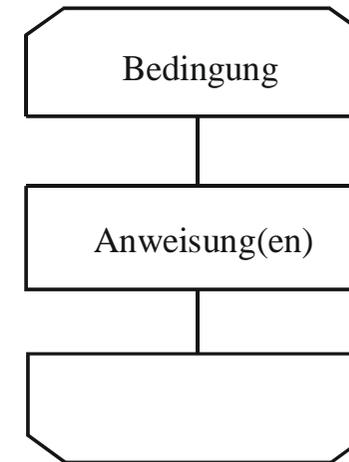
Die Bedingung wird vor der Ausführung der Schleife geprüft. Das Diagramm entspricht also einer `while`-Schleife.
