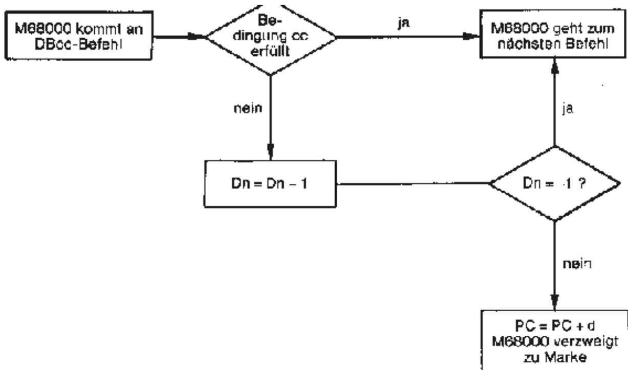
Die Bedingung für den DBcc-Befehl kann dabei mit denselben mnemonischen Codes angegeben werden wie im Bcc-Befehl. Im Gegensatz zum Bcc-Befehl wird jedoch hier nur verzweigt, wenn die Bedingung NICHT erfüllt ist. Bei erfüllter Bedingung verzweigt der DBcc-Befehl nicht!
