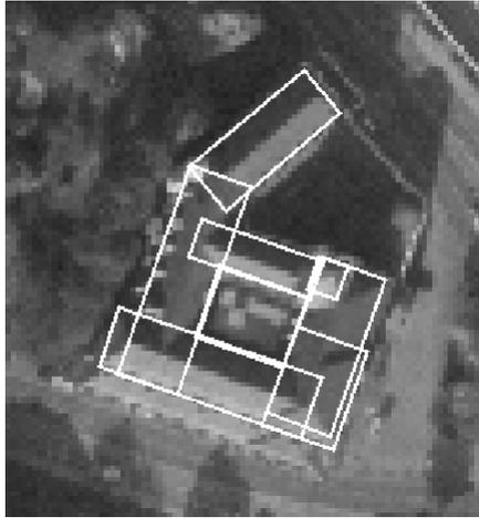
Rechteckszerlegung des Grundrisses
