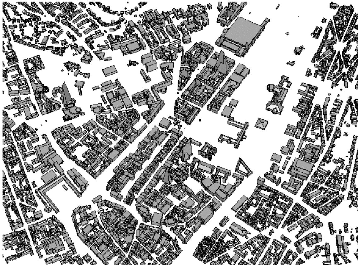
Ergebnis der automatischen Gebäudekonstruktion am Beispiel eines 1,8 km x 2,3 km großen Teilgebiets von Stuttgart mit 5208 Gebäuden
