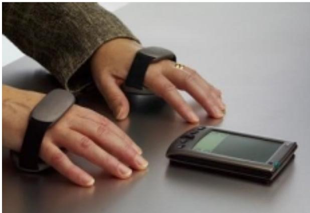
Durch das Senseboard wird eine herkömmliche Tatstatur simuliert. Sensoren zeichnen die Fingerbewegungen auf, die über künstliche Intelligenz gepaart mit einem Sprachprozessor in Mausbewegungen oder Tastenanschläge umgesetzt werden.
