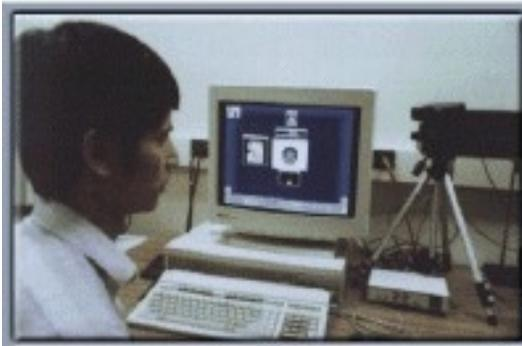
Im Rahmen einer multimodalen Interaktion ist es oftmals notwendig, die Position einer Person und deren Kopfhaltung zu erfassen. Das Robotic Institute entwickelt eine Benutzerschnittstelle, mit Hilfe derer der Kamerafokus auf ein bewegtes Objekt schwenkt. Mit diesem System wird es dem Vortragenden möglich, sich frei durch den Raum zu bewegen, ohne eine feste Kameraposition berücksichtigen zu müssen.
