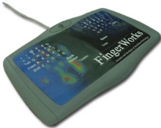
Das Fingerworks soll ebenfalls eine herkömmliche Tastatur ersetzen. Im Gegensatz zum Senseboard kann der Benutzer durch bestimmte Gesten die Mausbewegungen simulieren. Texteingaben erfolgen über eine Soft-Tastatur. Laut Hersteller ist ein Absetzen der Hände von Tastatur zur Bedienung von Mausfunktionen nicht mehr notwendig. Ferner soll dadurch dem Karpaltunnelsyndrom (Einengung eines Nervs der Hand) vorgebeugt werden.
