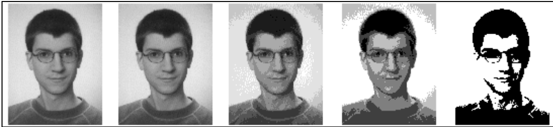
Abbildung 2-6 : Der Quantisierungsfaktor nimmt von links nach rechts zu. Im linken Originalbild sind 160 Graustufen, in den folgenden Bildern sind es 80, 10, 5 bzw. 2 Grauwerte.
