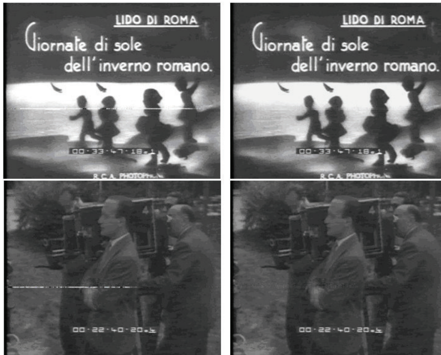
Abbildung 9: Beispiele zur Entfernung einer Störlinie
